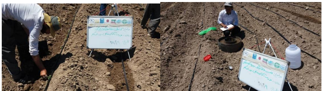
عملیات پایش برای بهره وری بیشتر از منابع آبی منطقه- استفاده از دابل رینگ جهت برآورد میزان نفوذپذیری خاک
