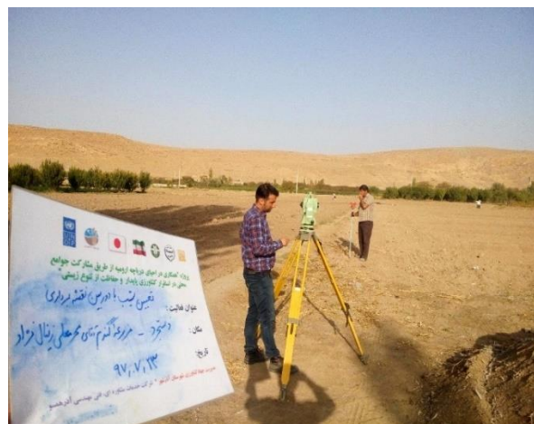
شکل ۲-۴: استفاده از دوربین نقشه‌برداری جهت اندازه‌گیری شیب (سمت راست)، تسطیح زمین با لولر (سمت چپ)
