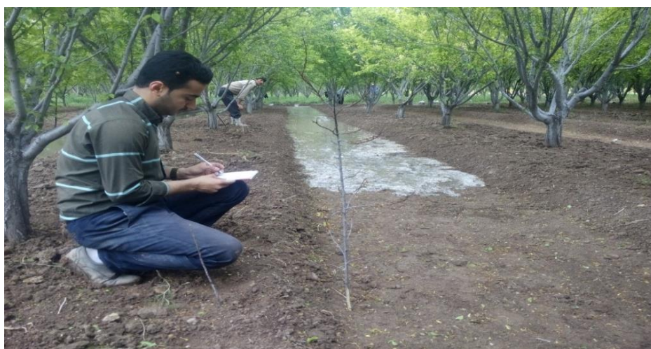
شکل ۹: جریان آب در داخل شیاری و اندازه‌گیری پیش‌روی آب
