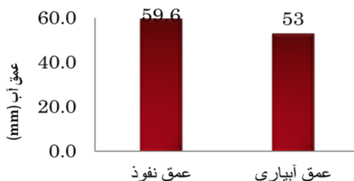
شکل ۸-۴-۱- برآورد میزان آب داده شده از طریق پیش روی و پسروی و معادله نفوذ (تیمار) در آبیاری اول
