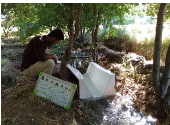
اندازه گیری دبی آب با استفاده از فلوم تیپ ۴ باغ آقای سهراب جمشیدی
