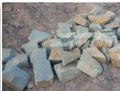
شکل شماره «۴۱»: سنگ‌های موجود در معادن اطراف تالاب اکثراً سنگ مالون هستند - سنگ مالون قرمز دست تراش (سمت راست) - سنگ مالون سبز (وسط) - سنگ مالون سفید آهکی (سمت چپ). سنگ‌ها به صورت برش منظم با ابزار هم مورد استفاده قرار می‌گیرند.
