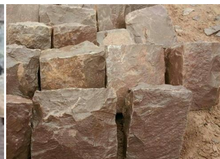
شکل شماره «۴۱»: سنگ‌های موجود در معادن اطراف تالاب اکثراً سنگ مالون هستند - سنگ مالون قرمز دست تراش (سمت راست) - سنگ مالون سبز (وسط) - سنگ مالون سفید آهکی (سمت چپ). سنگ‌ها به صورت برش منظم با ابزار هم مورد استفاده قرار می‌گیرند.
