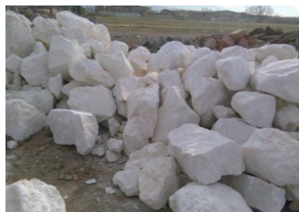
شکل شماره «۴۱»: سنگ‌های موجود در معادن اطراف تالاب اکثراً سنگ مالون هستند - سنگ مالون قرمز دست تراش (سمت راست) - سنگ مالون سبز (وسط) - سنگ مالون سفید آهکی (سمت چپ). سنگ‌ها به صورت برش منظم با ابزار هم مورد استفاده قرار می‌گیرند.
