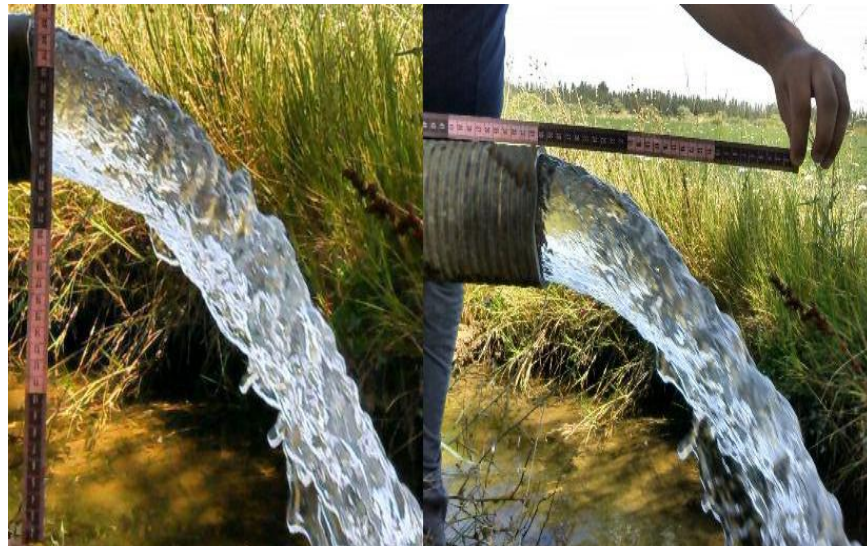
شکل ۳-۲۰- اندازه‌گیری دبی به روش نیمرخ پرتابه‌ای افقی در مزرعه H i - کانون میان‌دوآب
