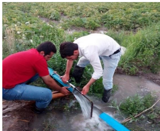
شکل ۳-۴- اندازه‌گیری دبی با استفاده از خط‌کش جت
