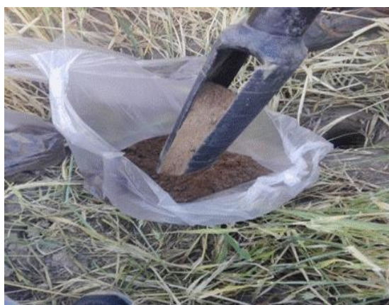
شکل ۳-۱۱- برداشت نمونه خاک به‌منظور اندازه‌گیری مشخصات فیزیکی و شیمیایی خاک
