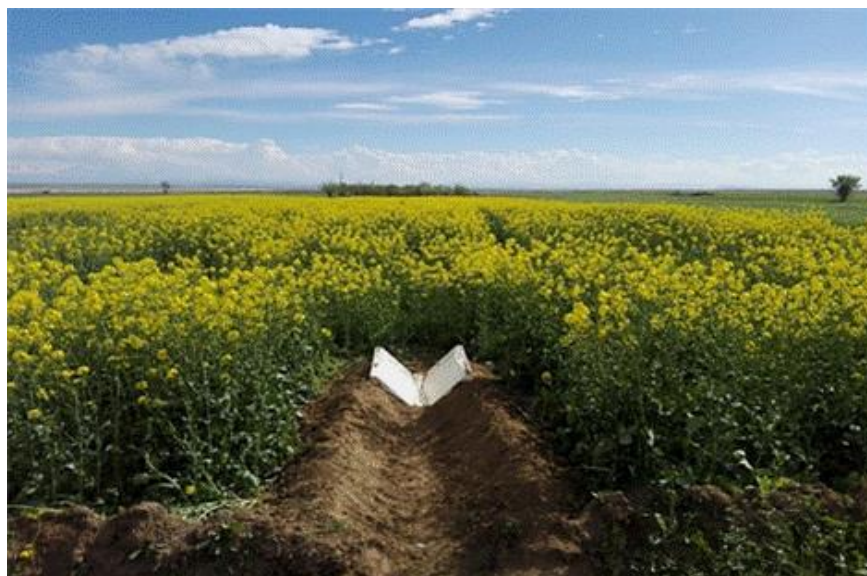
شکل ۳-۲- فلوم نصب‌شده با ایجاد مسیر انحرافی (مزرعه کلزا)
