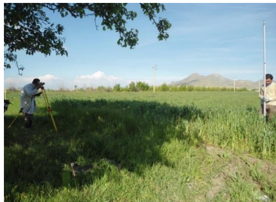
شکل ۳-۱۲- نقشه‌برداری جهت اندازه‌گیری شیب طولی
