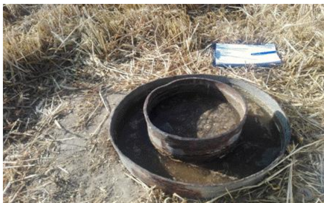
شکل ۳-۱۴- اندازه‌گیری سرعت نفوذ آب در خاک
