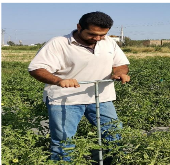
شکل ۳-۶- اندازه‌گیری رطوبت خاک به‌صورت دستی
