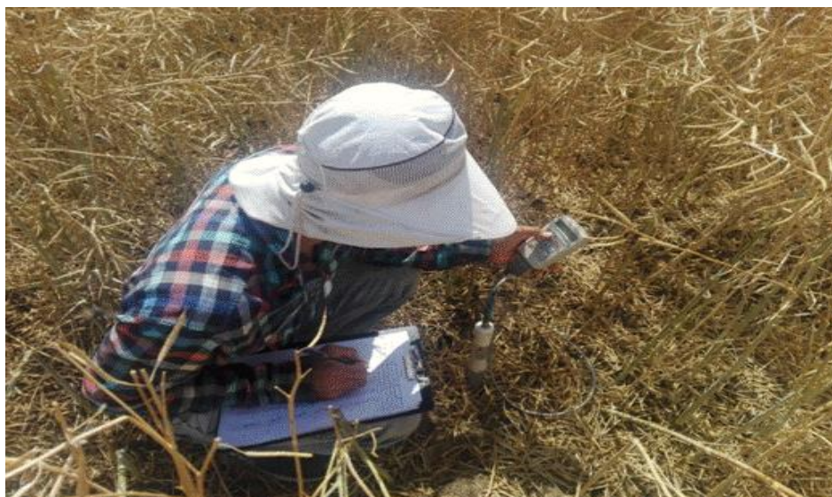
شکل ۳-۷- برداشت قرائت رطوبت با دستگاه PR2
