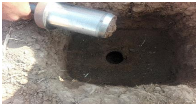
شکل ۳-۱۵- برداشت نمونه دست‌نخورده خاک به‌منظور اندازه‌گیری چگالی ظاهری
