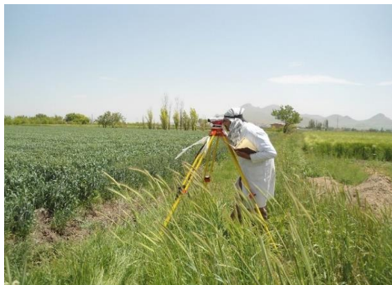
شکل ۳-۱۲- نقشه‌برداری جهت اندازه‌گیری شیب طولی
