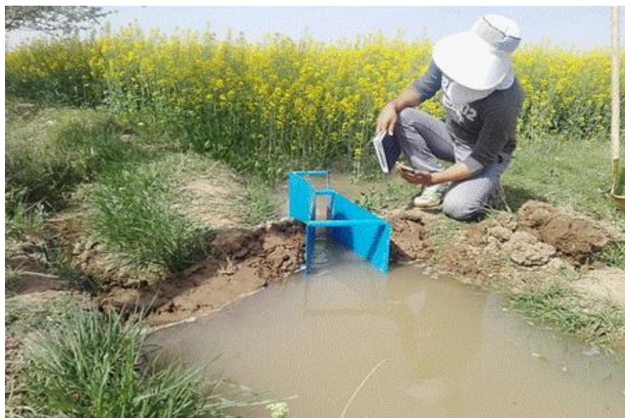
شکل ۱-۳- اندازه‌گیری حجم آب ورودی به مزرعه توسط فلوم
