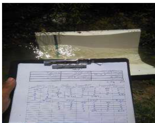
شکل ۳-۳- قرائت اشل فلوم و ثبت آن به‌صورت لحظه‌ای
