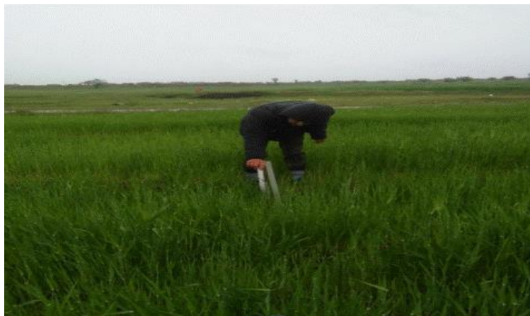
شکل ۳-۸- اندازه‌گیری عمق آب آبیاری در طول کرت‌ها
