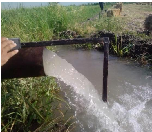
شکل ۳-۴- اندازه‌گیری دبی با استفاده از خط‌کش جت
