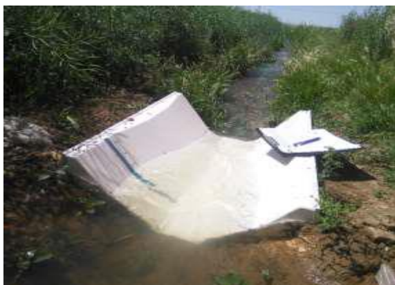
شکل ۳-۳- قرائت اشل فلوم و ثبت آن به‌صورت لحظه‌ای
