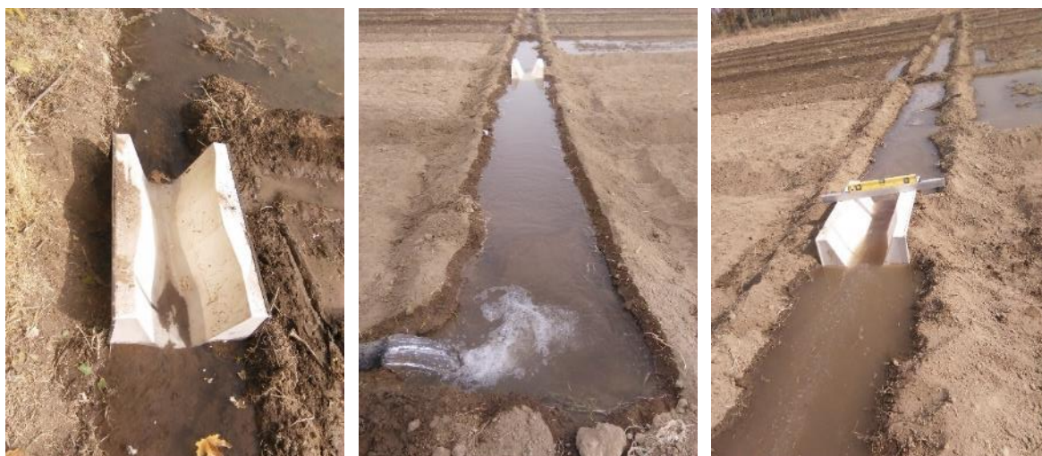
شکل ۵۷- اندازه‌گیری آب آبیاری به وسیله فلوم WSC در مزرعه W1 تا W3 (پایش اصلی)
