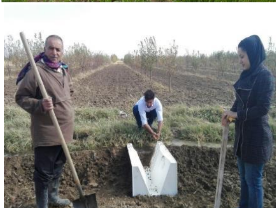
شکل ۵۸- اندازه‌گیری آب آبیاری به وسیله فلوم WSC در مزارع پایش شرکت‌های فنی مهندسی
