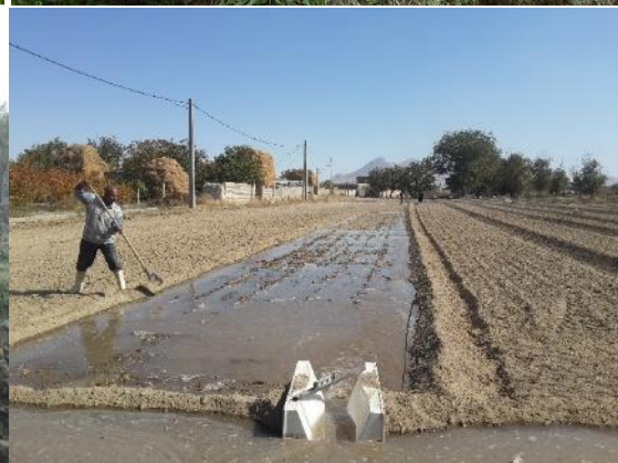
شکل ۵۸- اندازه‌گیری آب آبیاری به وسیله فلوم WSC در مزارع پایش شرکت‌های فنی مهندسی
