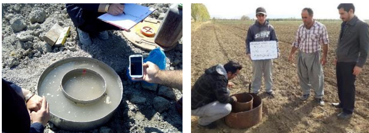
شکل ۶۰- اندازه‌گیری نفوذ به روش استوانه‌های مضاعف در مزارع مورد مطالعه
