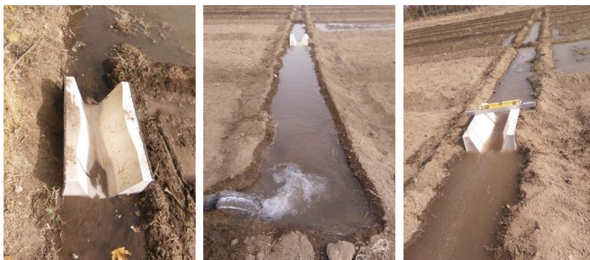
شکل ۵۷- اندازه‌گیری آب آبیاری به وسیله فلوم WSC در مزرعه W1 تا W3 (پایش اصلی)
