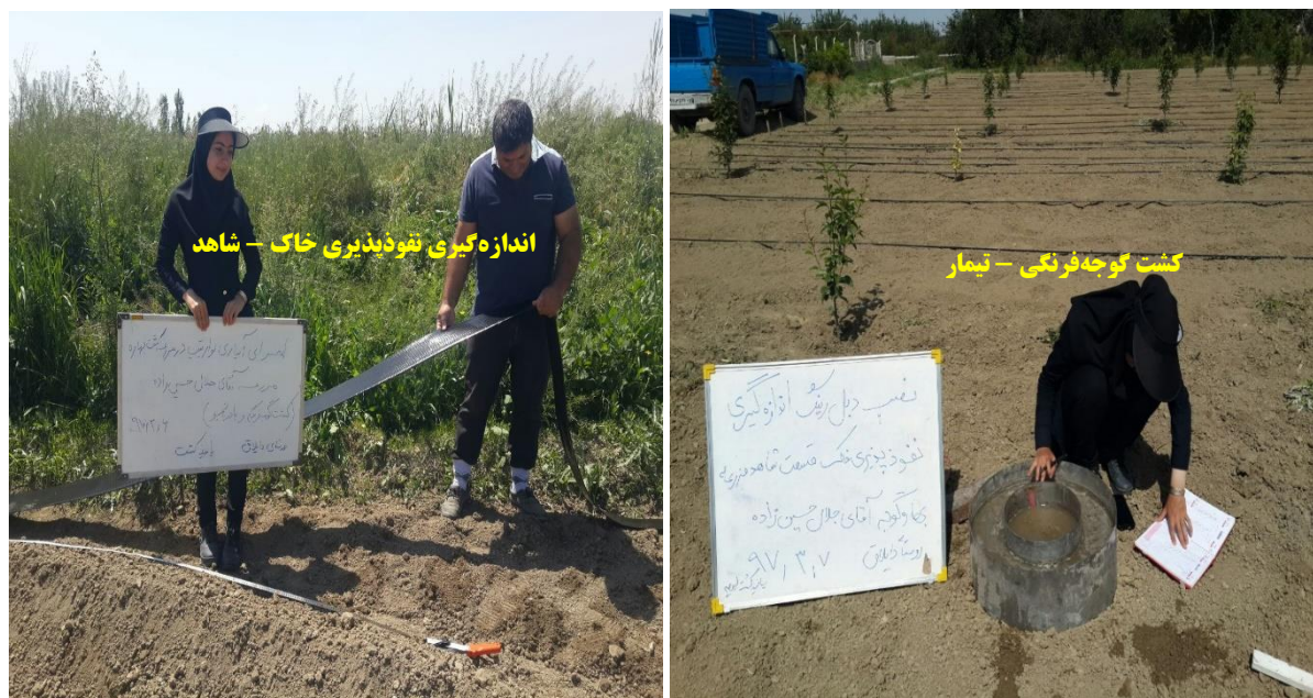
شکل ۲۷۹- عملیات کشت گوجه‌فرنگی و اندازه‌گیری نفوذپذیری خاک در مزرعه S17
