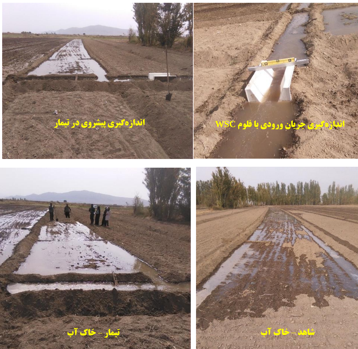
شکل ۶۳- پایش و اندازه‌گیری آبیاری در مزرعه W1 در آبیاری اول (۹۶/۸/۲)
