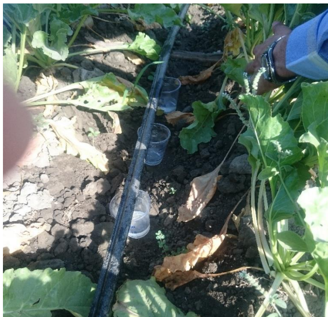
شکل ۲۶۵- اندازه‌گیری دبی نوار تیپ در آبیاری دوم مزرعه S15
