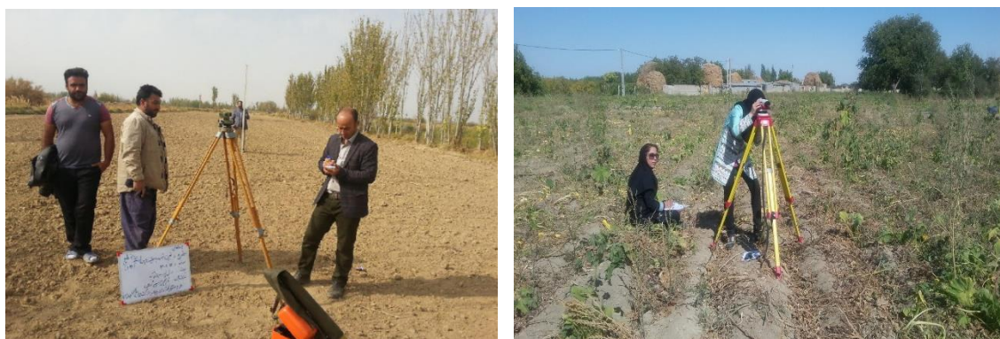
شکل ۶۱- نقشه‌برداری و تعیین ابعاد، شیب و توپوگرافی در مزارع مورد مطالعه
