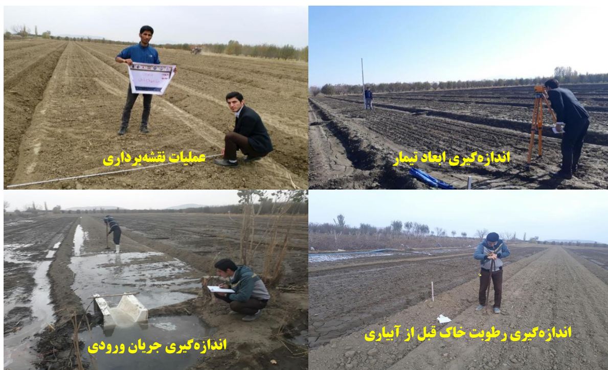
شکل ۱۴۷- پایش و اندازه‌گیری آبیاری، اندازه‌گیری رطوبت خاک، اندازه‌گیری ابعاد و نقشه‌برداری زمین در مزرعه W14
