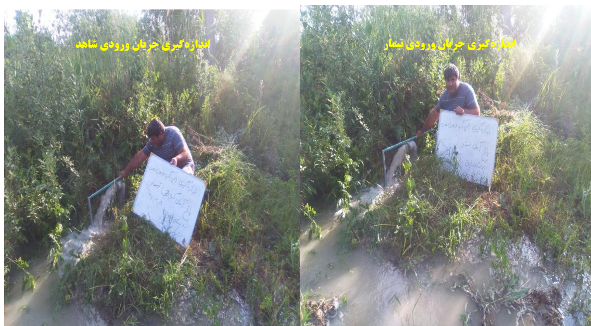
شکل ۲۸۴- اندازه‌گیری جریان ورودی با روش جت در باغ S18
