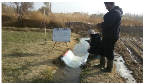
شکل ۸۲- اندازه‌گیری آب آبیاری به وسیله فلوم WSC در مزارع تحت پایش
