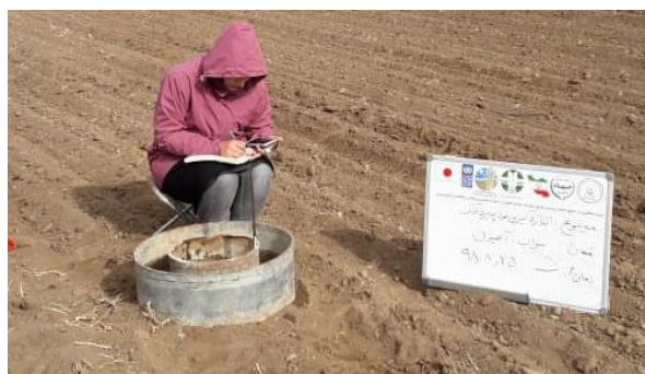
شکل ۸۴- اندازه‌گیری نفوذ به روش استوانه‌های مضاعف در مزارع مختلف
