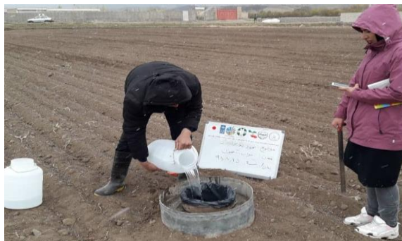
شکل ۸۴- اندازه‌گیری نفوذ به روش استوانه‌های مضاعف در مزارع مختلف
